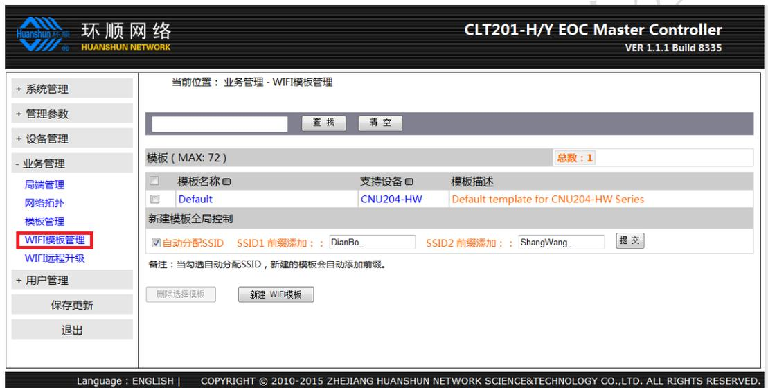
WIFI 终端设备使用的 WIFI 模板, 局端设备已有默认的 WIFI 模板 1 个, 支持 CNU204-HW 型号的终端设备, 用户可根据自己的需要修改默认模板, 但不能删除默认模板;
