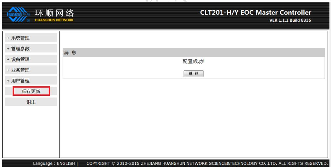
保存设置和配置信息，对系统进行操作之后需要保存配置，否则设备上电后将恢复到上次保存的状态；
