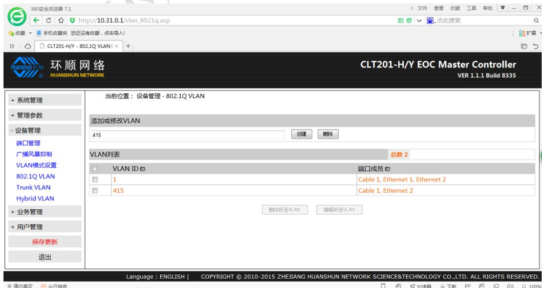
在“VLAN ID”中输入 415，点击创建，完成 VLAN 创建。
