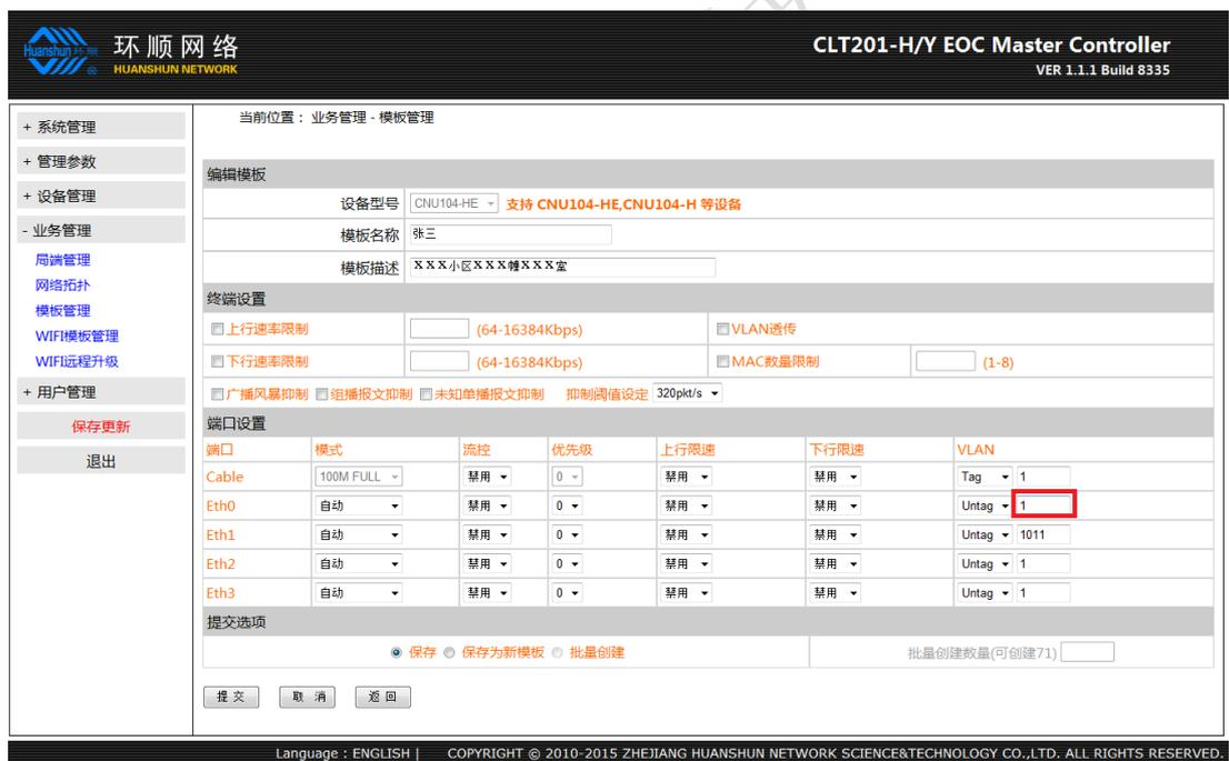
【模板列表】中点击张三的模版，将点播的 VLAN 968 修改为 VLAN 1，点击【确认】完成模版编辑。局端重新下发配置，用户张三只能上网。
