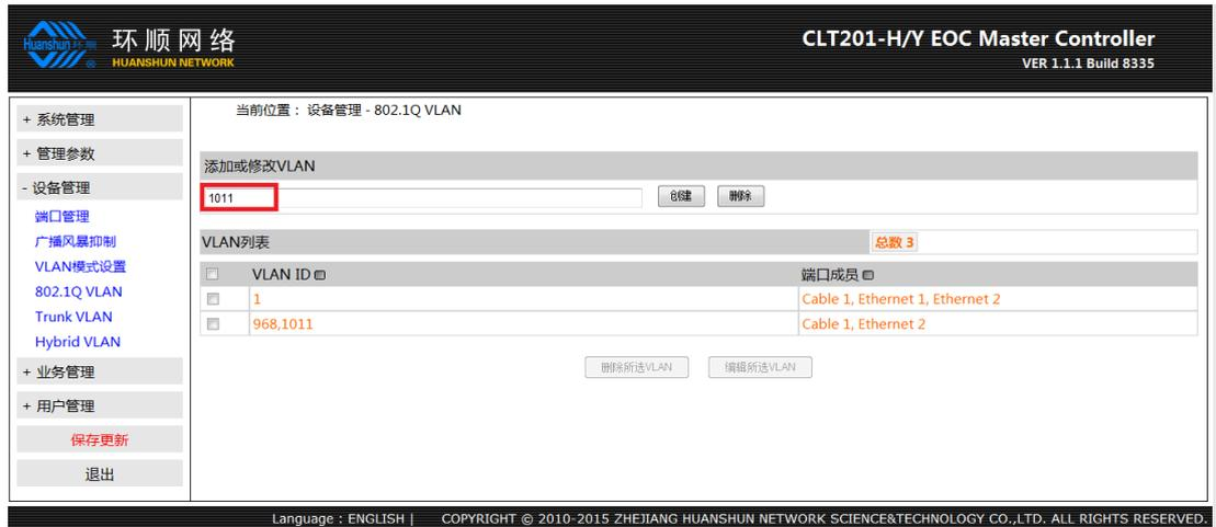
【802.1Q VLAN】页面中在 VLAN ID 输入框输入 968，点击【新建 VLAN】；
