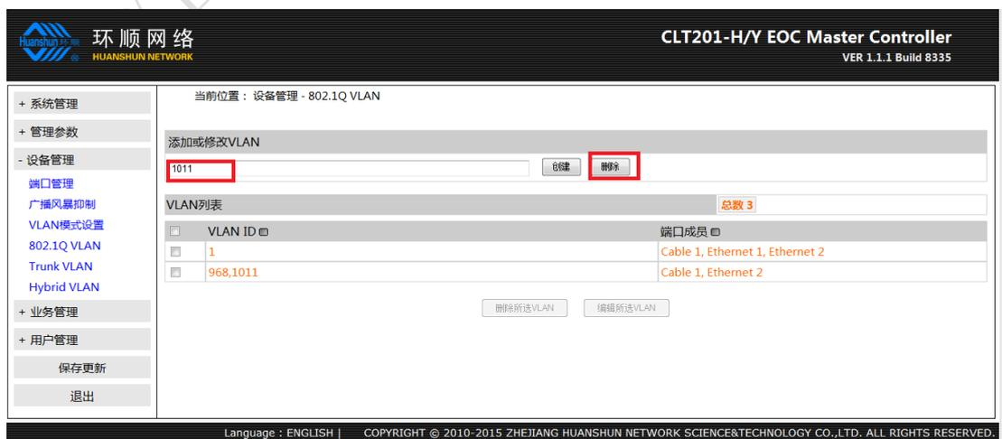
【802.1Q VLAN】中选择 VLAN 1011，点击【删除选择的 VLAN】完成 VLAN 删除。
